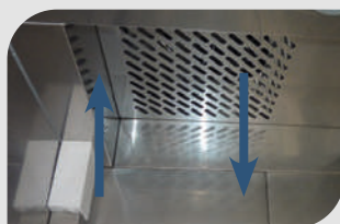
Circulation optimale de l'air dans l'enceinte
