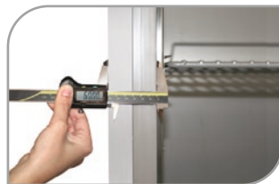
Epaisseur d'isolation : 60 mm
